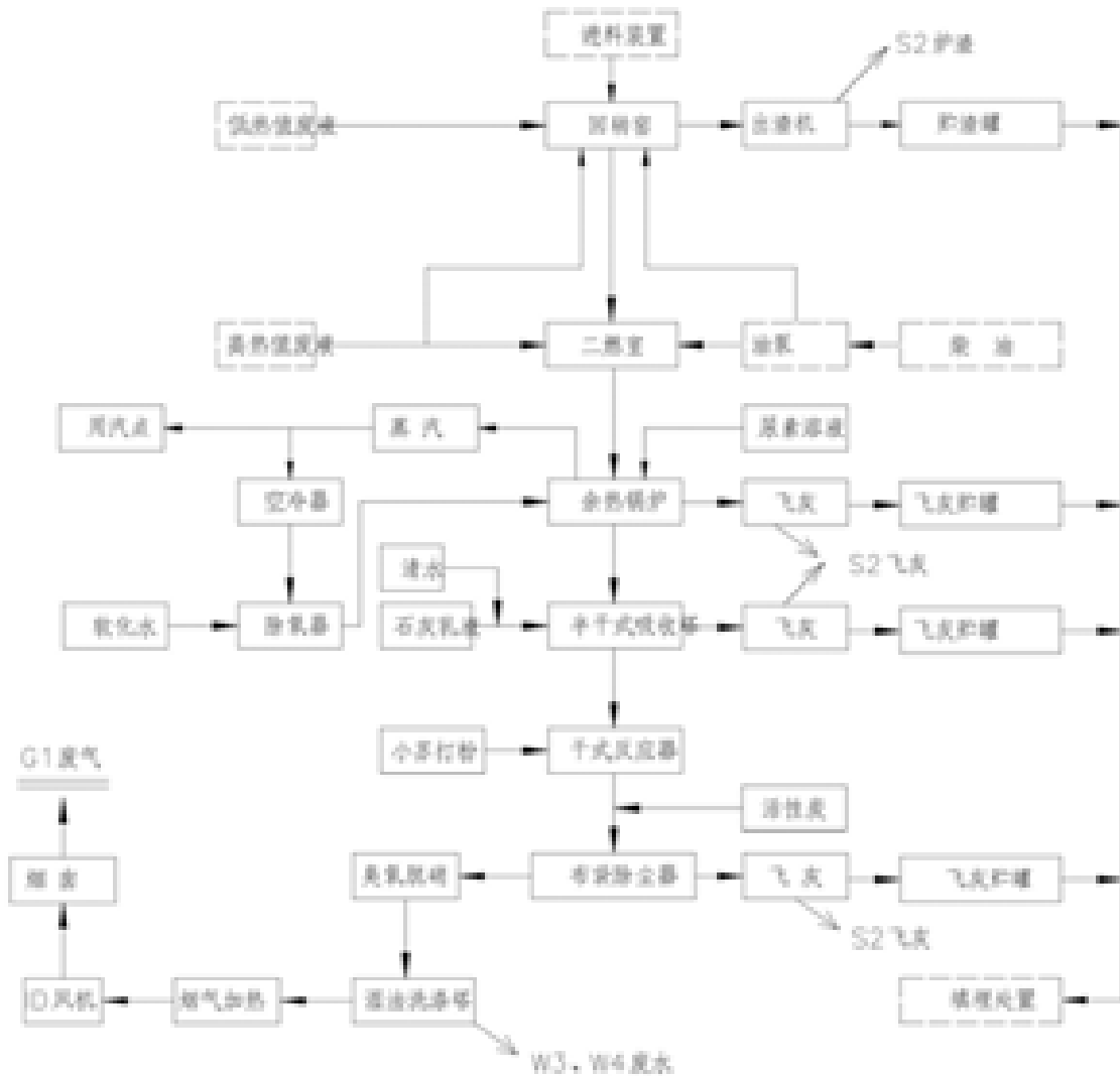
图 3.6-4 危险废物焚烧处理工艺流程图
