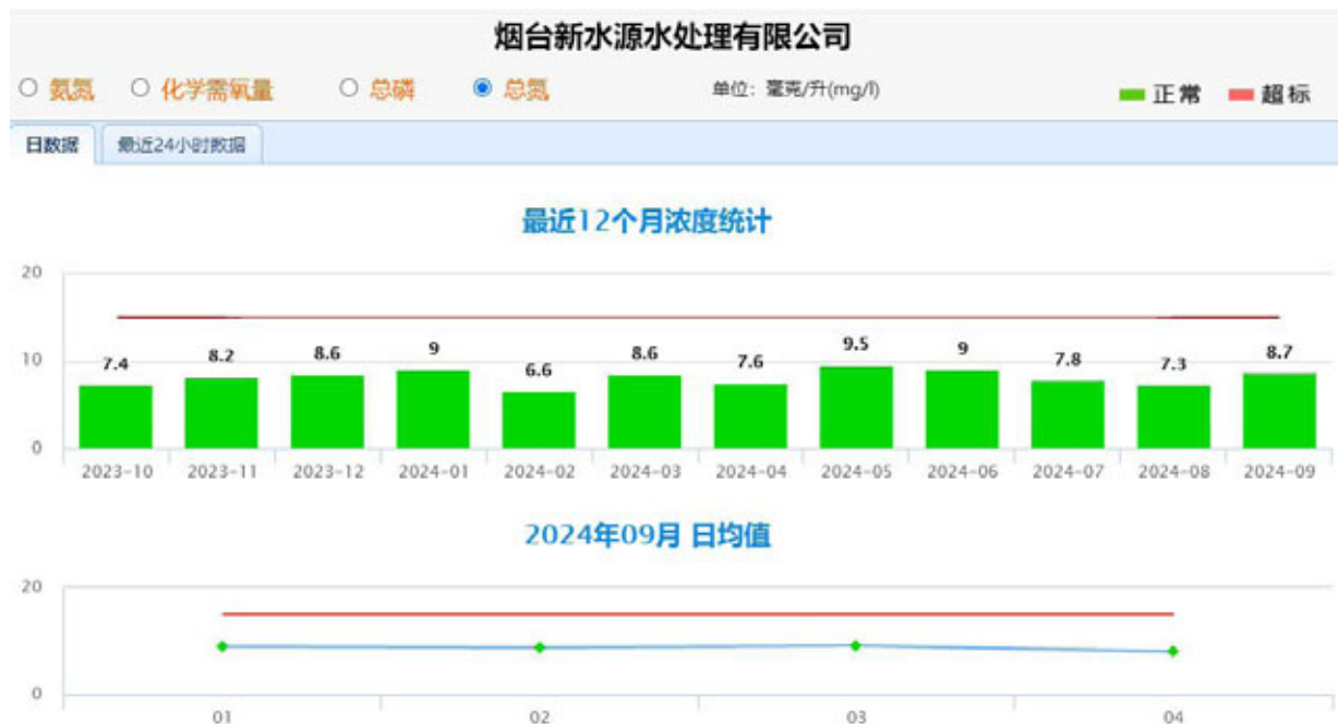
图 3.5-5 烟台新水源水处理有限公司近 12 个月总氮在线监控数据
